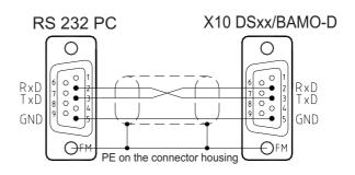
Bei starken Störungen auf der Schnittstelle sollte ein Leitungsfilter eingesetzt werden. Laptop mit USB-RS232 Konverter sind meist störempfindlich.
